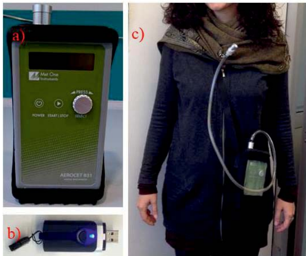
Figura 1: Strumentazione per il monitoraggio dell'esposizione: (a) strumento per la misura in continuo delle concentrazioni di PM (Aerocet 831), (b) sistema GPS miniaturizzato; (c) strumentazione modificata per esecuzione di campionamento personale (prelievo in zona respiratoria)
