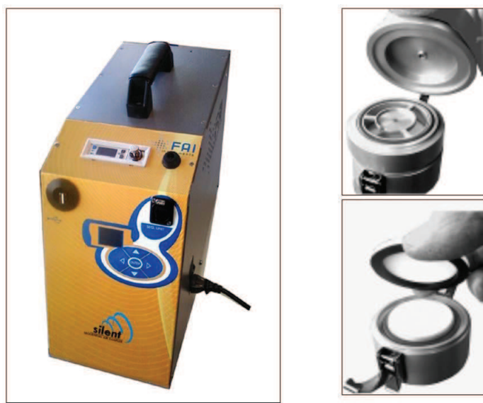
Figura 2.1 - Campionatore gravimetrico di PM_{2.5} con portafiltro da 47 mm.
