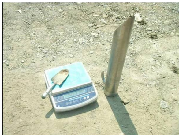
Figura 16 : Strumentazione utilizzata per la determinazione del peso di volume sui materiali al momento dell’abbancamento. La fustella, creata ad hoc per le analisi, ha un volume di 3,927 L.
