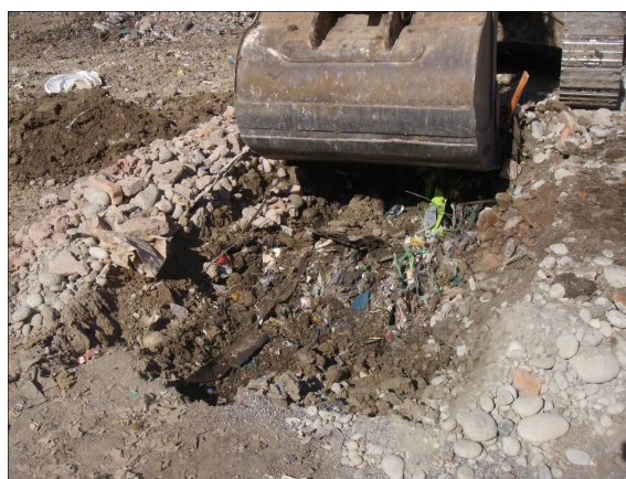
Figura 24 : Al termine della prova, lo scavo del pozzetto consente di verificare la stratigrafia della porzione di cumulo interessato dall’applicazione dei carichi; nella Prova n. 3, al di sotto di un livello di materiale sfuso con spessore di 20 ÷ 30 cm è presente un livello di balle costituite da rifiuti assimilabili agli urbani, con prevalenza di materiali molto deformabili.
