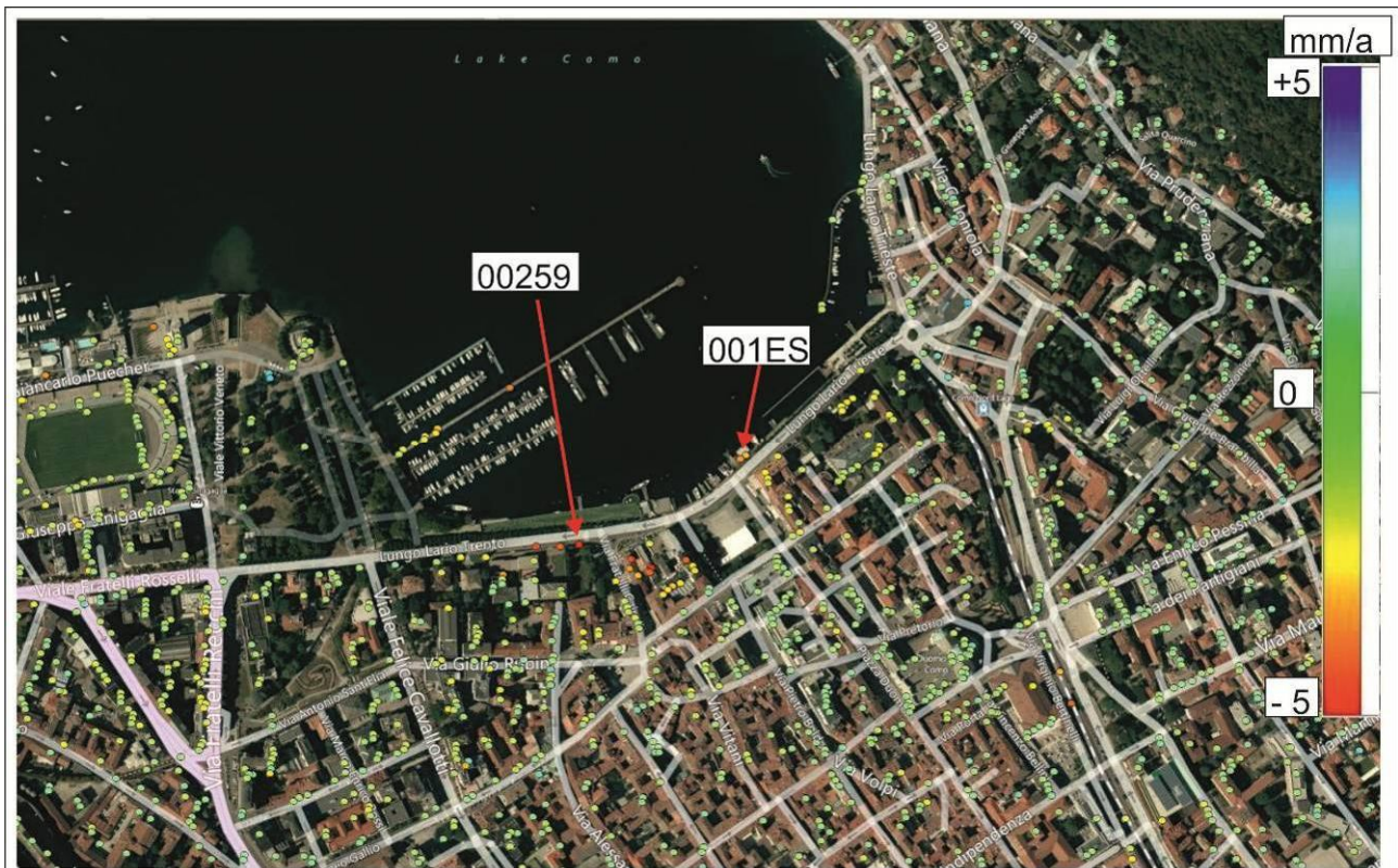
Figura 52 : Ubicazione dei bersagli analizzati da TRE per l'elaborazione delle misure di interferometria radar nel settore del Lungario Trento; il codice di colore si riferisce alla velocità media di spostamento verticale del terreno nell'intervallo 2003 ÷ 2012; in particolare, i punti rossi sul Lungario Trento presentano velocità di subsidenza dell'ordine di 5 mm/anno.
