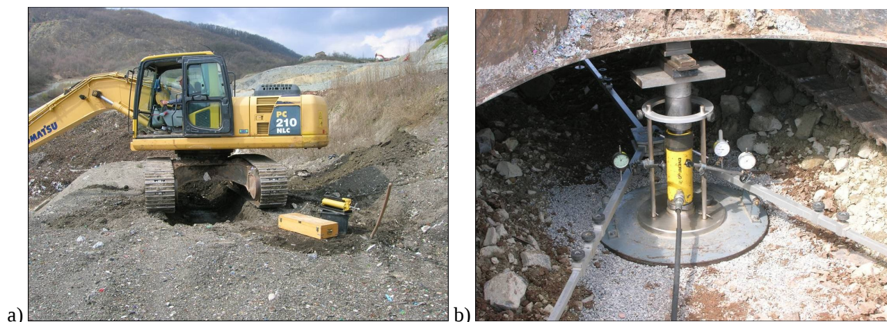
Figura 23 : a) Posizionamento dell’escavatore (del peso operativo di 21 t) con funzione di mezzo di contrasto e preparazione della postazione di prova. È ben visibile la composizione del cumulo, in questo caso comprendente terre granulari medio-grossolane (Prova n. 1); b) Configurazione della strumentazione nella Prova di carico n. 2; si può notare il velo di sabbia steso alla base per rendere omogeneo il piano di appoggio, il pistone idraulico posto a contrasto con il telaio dell’escavatore e i 3 comparatori posizionati sulla piastra, con riferimento al “compasso” a 3 braccia poggiate al di fuori dell’area di risentimento dei carichi.
